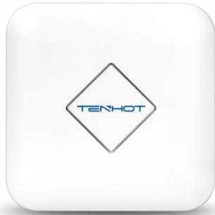
XS800 是一款支持 802.11AC 技术的高性能企业级双频吸顶 AP 产品，能同时工作在 2.4G/5.8G 两个频段，并满足 100 人同时无线高速上网的需求。全千兆网络接口，2.4G 802.11N 300Mbps + 5G 802.11AC 900Mbps 的无线接入速度，无线处理速度最高可达 1200Mbps。具有高性能、高增益、高接收灵敏度、高带宽、高接入数等特点，不仅能覆盖更大的范围，而且能提供更高的无线传输性能及稳定性。因地制宜，看你需求，胖瘦可选（V3 版本为胖 AP），是校园、企业办公、医院、会议厅等高密度环境无线接入的不二之选。
